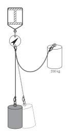
Die Prüfmasse von 200 kg wird mit der Kraftmessdose am Anschlagpunkt verbunden. Die Prüfmasse wird um die Höhe angehoben und fallengelassen, die erforderlich ist um eine Spitzenauffangkraft von 9 kN zu erzeugen.
